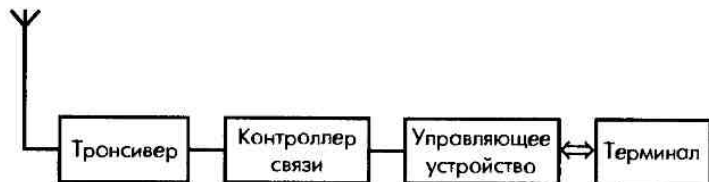
Рис. 2.8. Структура устройства Bluetooth
