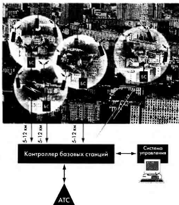
Рис. 2.34. Микросотовая сеть связи
