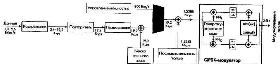
Рис. 2.41. Схема передачи в прямом канале cdmaOne
