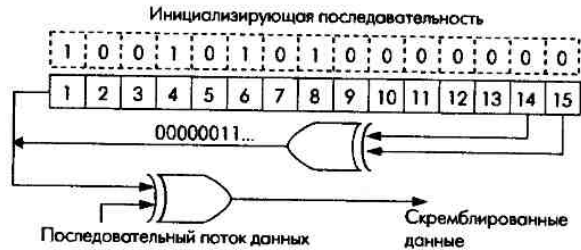
Рис. 8.4. Генерация ПСП для рандомизации данных
