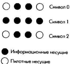
Рис. 8.20. Структура «фрагмента» восходящего канала
