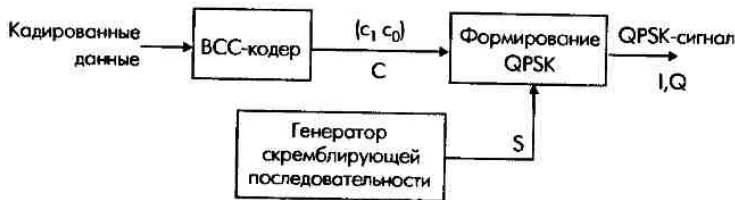
Рис. 6.7. Общая схема PBCC-модуляции
