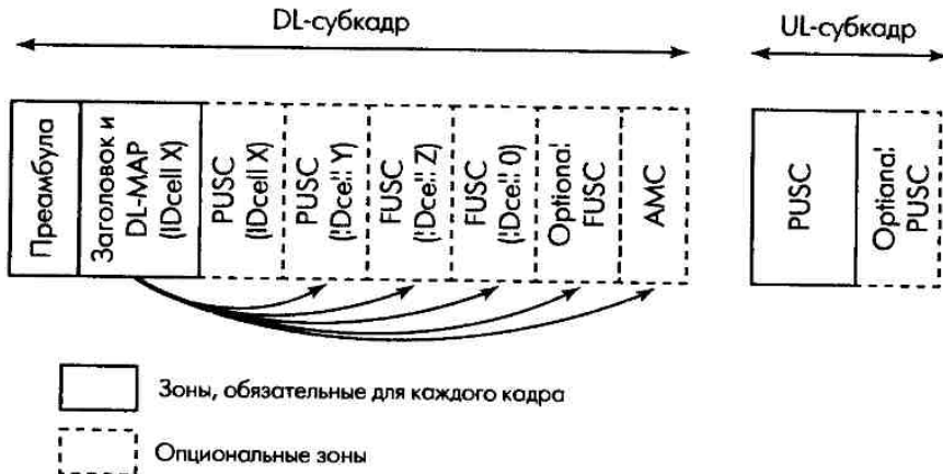
Рис. 8.18. Совмещение различных «зон перестановки» в OFDMA-кадре
