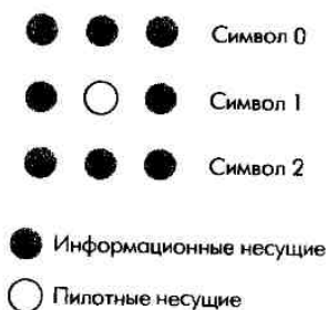
Рис. 8.21. Структура «фрагмента» восходящего канала в опциональном режиме
