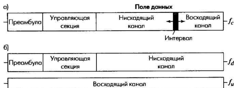
Рис. 8.5. Структура кадра в стандарте IEEE 802.16 для систем с временным (а) и частотным (б) дуплексированием каналов
