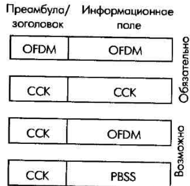
Рис. 6.14. Кадры IEEE 802.11g в различных режимах модуляции
