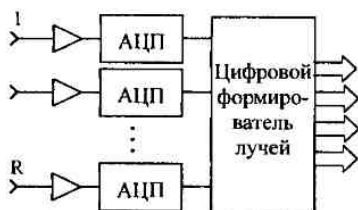
Рис. 9.53. Вариант структуры приемной ЦАР
