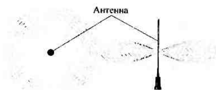
Рис. 9.12. Характеристика излучения несимметричного вертикального вибратора
