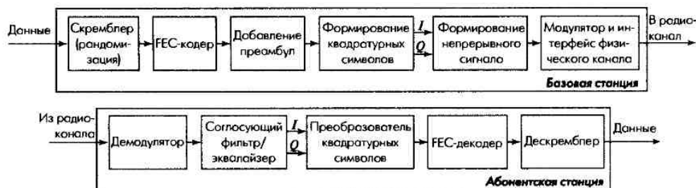
Рис. 8.3. Тракт формирования выходного сигнала в стандарте IEEE 802.16 (нисходящий канал)
