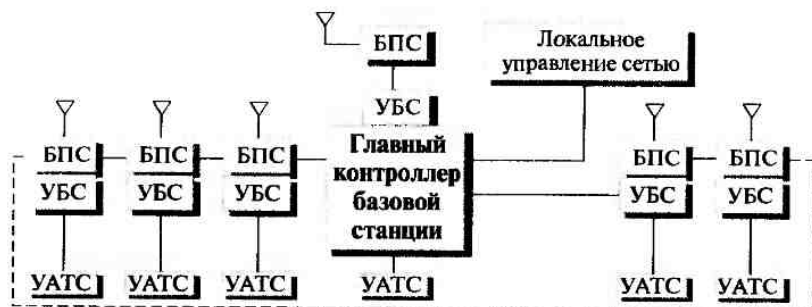
Рис. 2.50. Подсеть TETRA с конфигурацией типа «цепь»
