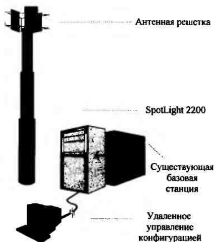
Рис. 9.63. Типовое оборудование базовой станции CDMA с ЦАР
