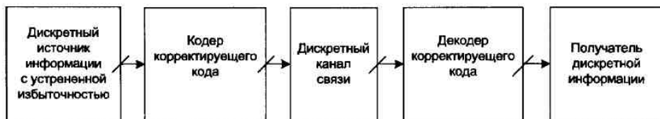
Рис. 4.3. Блок-схема системы связи при наличии кодера и декодера корректирующего кода
