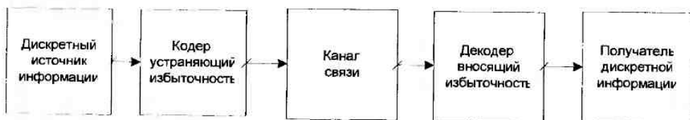
Рис. 4.1. Блок-схема системы передачи информации через идеальный канал связи
