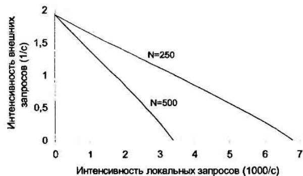
Рис. 7.10. Кривые ограничения нагрузки
