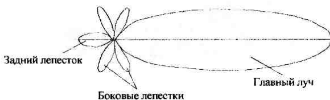
Рис. 9.18. Структурные элементы типовой диаграммы направленности
