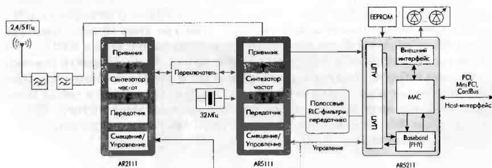
Рис. 2.32. Чипсет AR5001X Combo с поддержкой 802.11a/b/g компании Atheros
